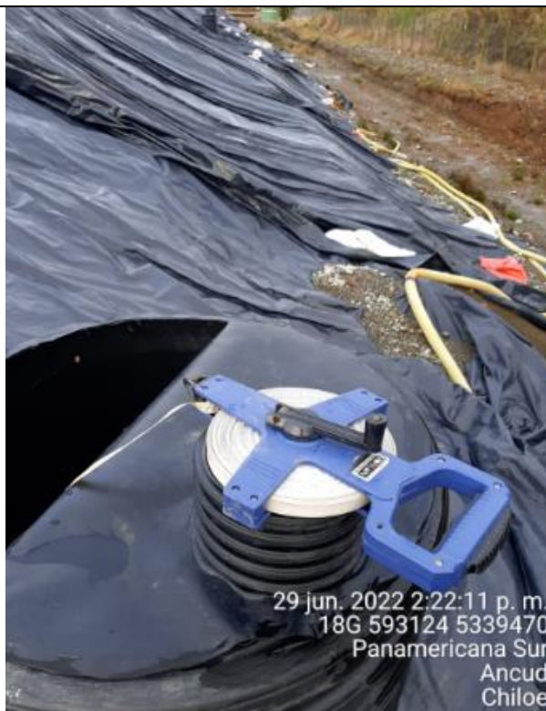
Fotografía N°34: Medición de Niveles de cámaras por Personal Municipal. Tomada: 29 de Junio del 2022.
